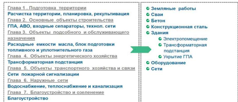
Рис. 4. Сравнение структуры стоимости объекта в российской и зарубежной структуре
